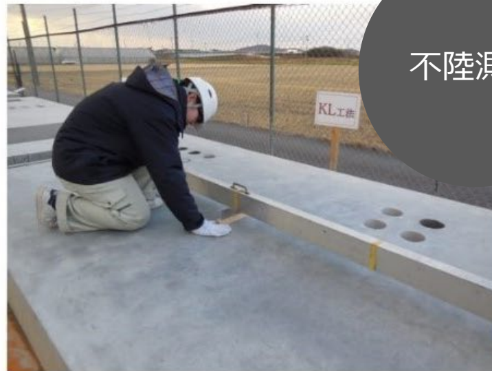
3m定規による平坦性測定
